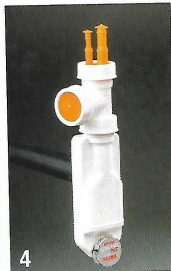
1. Per applicare il TEE in dotazione ed estendere il numero di ingressi nel sifone, va inserita la guarnizione rossa, che non serve nell'applicazione diretta dei raccordi, i quali sono conformati per provvedere anche alla sigillatura, stringendo la ghiera.
